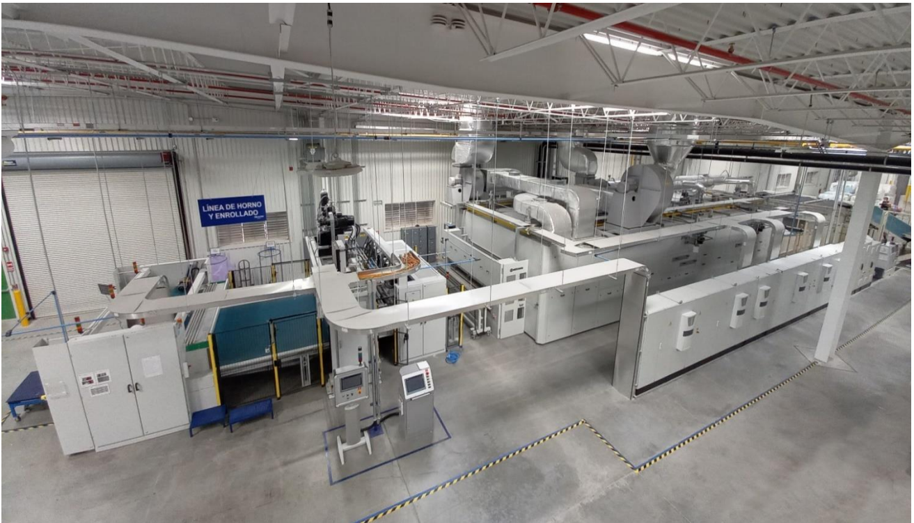
Foto 1: Doppelband-Thermofusionsofen SUPRA FLOW BX mit Rotationslängsschneider, Guillotinen-Querschneider und semi-automatischem Wickler zur Herstellung von voluminösen Vliesstoffen für die Möbelindustrie
